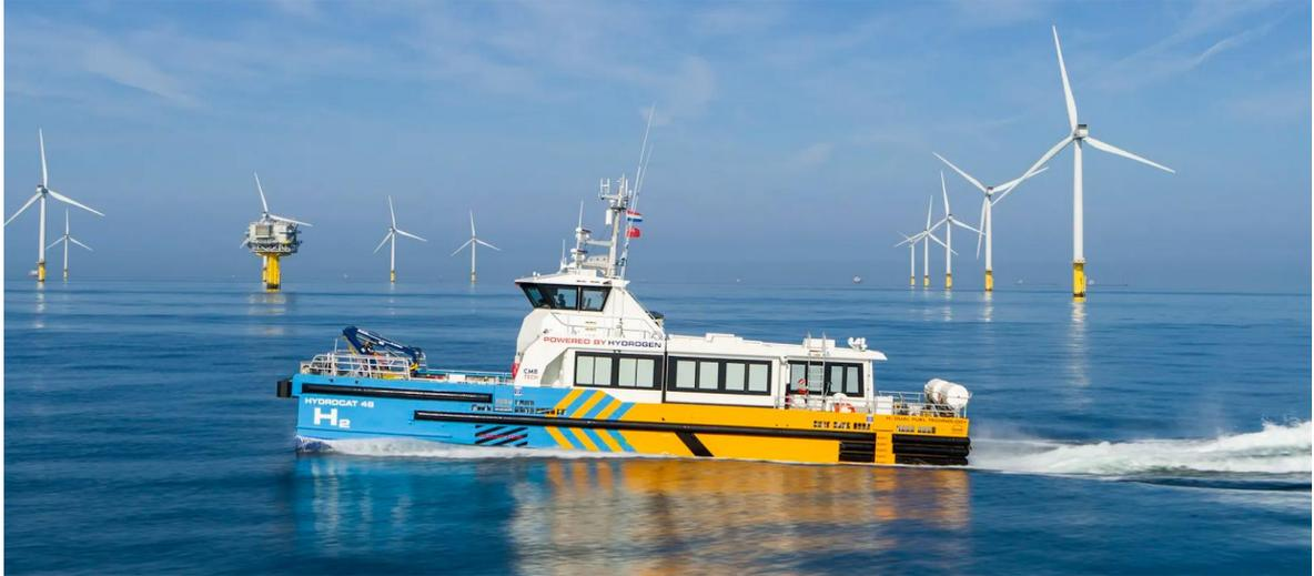
**Fig. 6.36:** Embarcación Hydrocat 48 propulsada por combustión dual diésel- H<sub>2</sub> [151].
