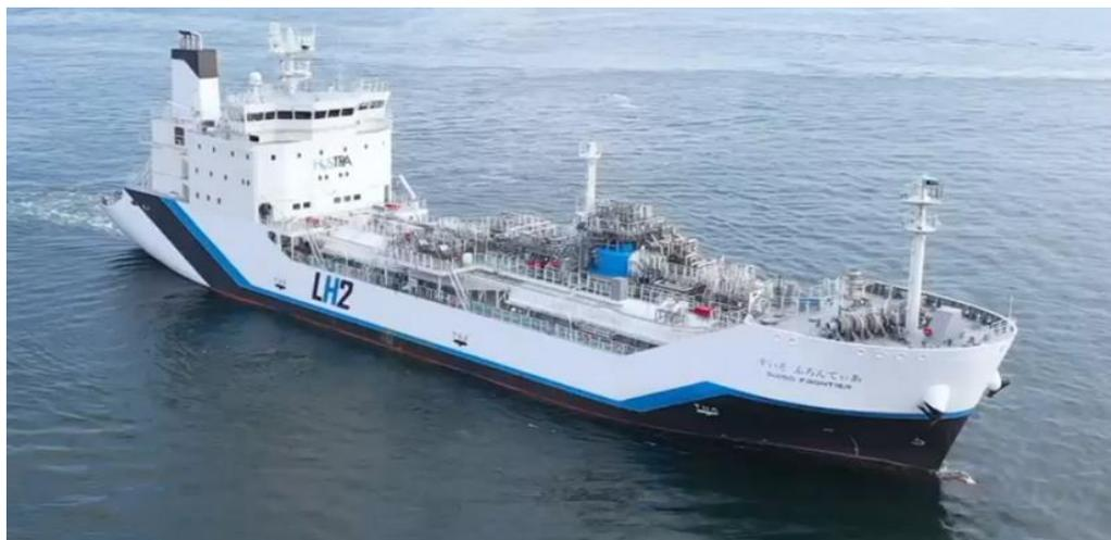
**Fig. 4.21:** Suiso Frontier, el primer barco de transporte de H<sub>2</sub> líquido [85].
