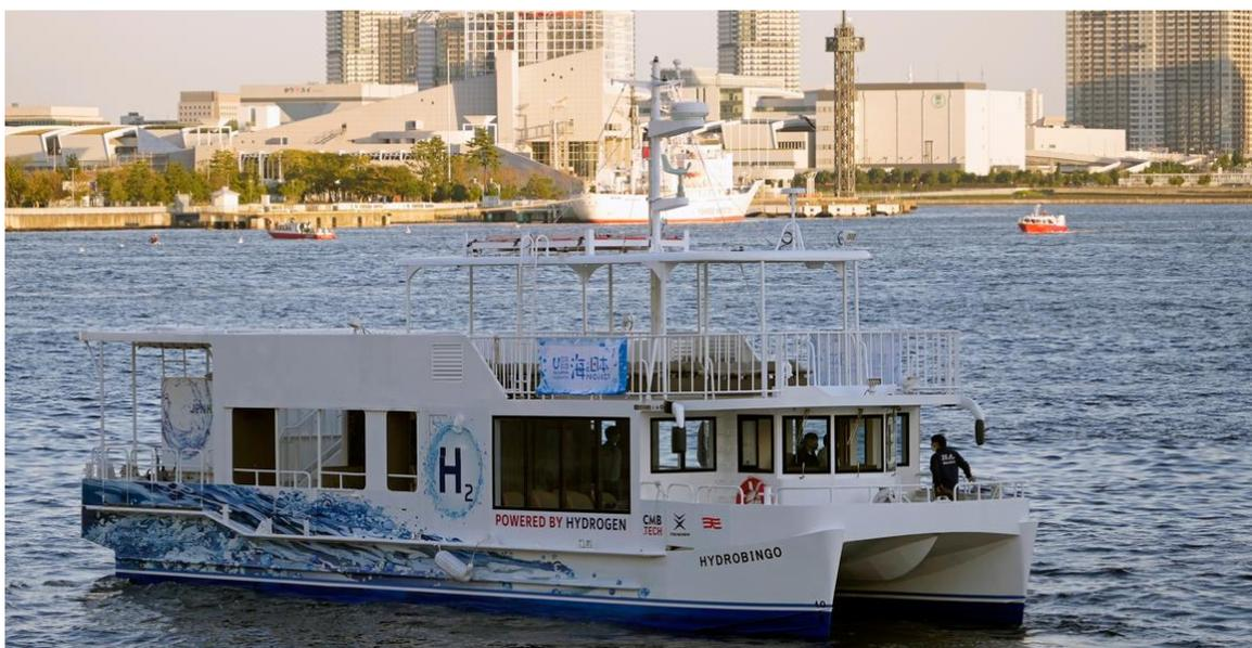
**Fig. 6.34:** Ferry Hydro Bingo impulsado por combustión dual diésel-H<sub>2</sub> [149].
