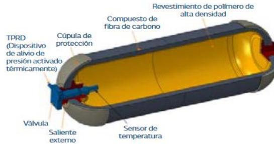
**Fig. 4.15:** Componentes del tanque presurizado para almacenamiento de H<sub>2</sub> [84].
