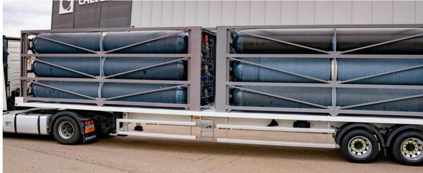
**Fig. 4.22:** Camión de tubo para transportar H<sub>2</sub> comprimido [86].
