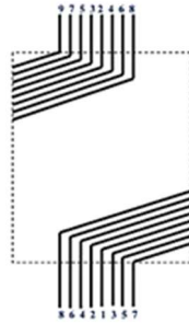
FIGURA 4.15. DEVANADO DE REGULACIÓN CON CONDUCTORES NUMERADOS.
