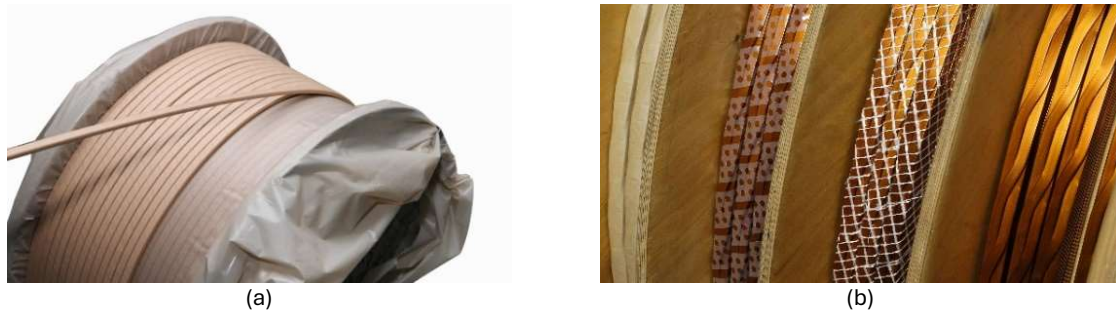
FIGURA 4.8. BOBINAS DE CONDUCTOR, (A) PICC Y (B) CTC.
