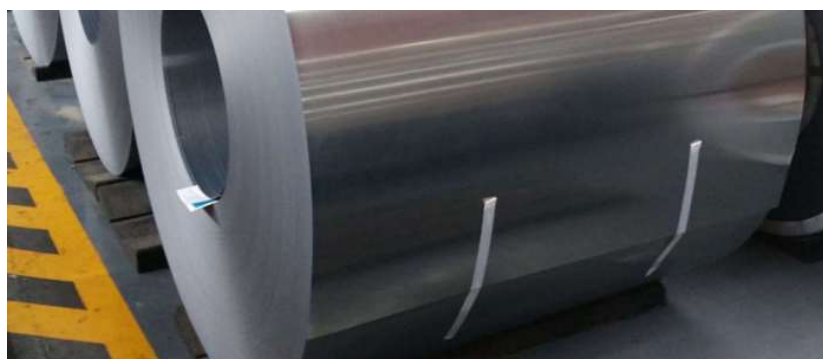
FIGURA 3.1. BOBINA DE CHAPA MAGNÉTICA PREVIA AL CORTE.
