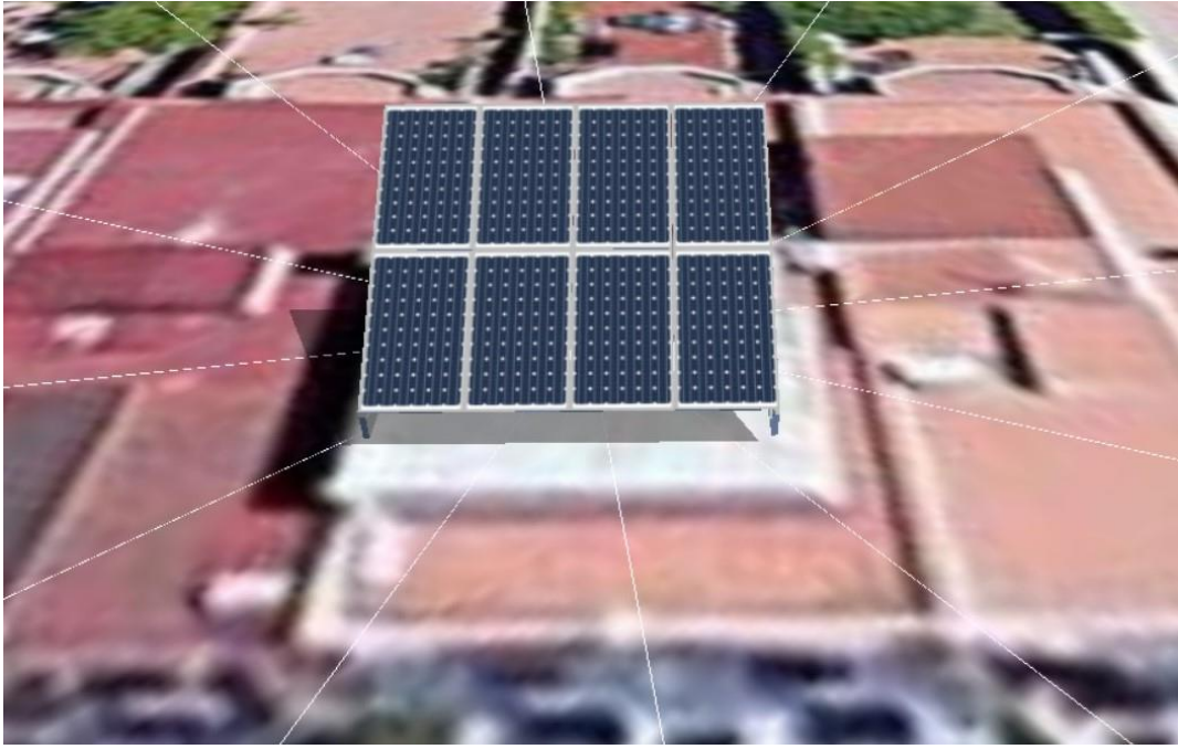
Figura 5-7. Vista frontal de la estructura soporte de los paneles.
