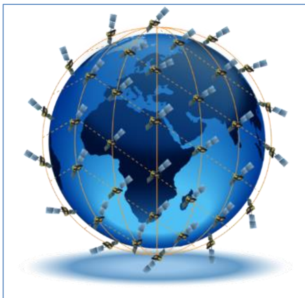
Figura 2.7. Diagrama ilustrativo de los planos orbitales de la constelación Iridium [12].
