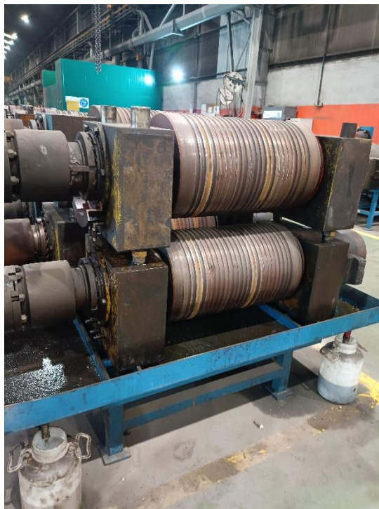
Figura 5- Cilindros de laminación en el taller de reparación
