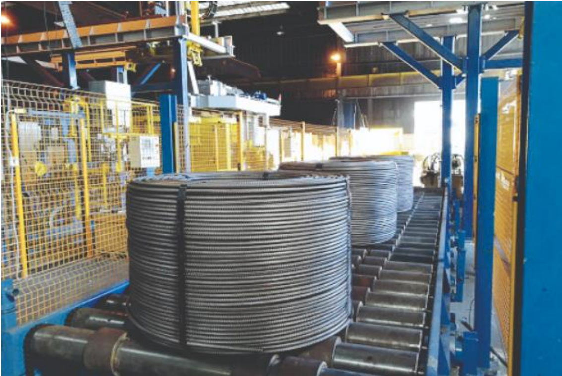
Figura 18- Bobinas sobre camino de rodillos (Danieli, s.f.)
