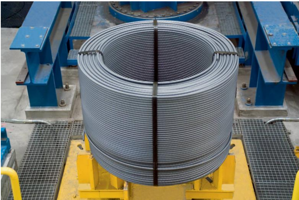
Figura 17- Bobina con flejes colocados (Danieli, s.f.)
