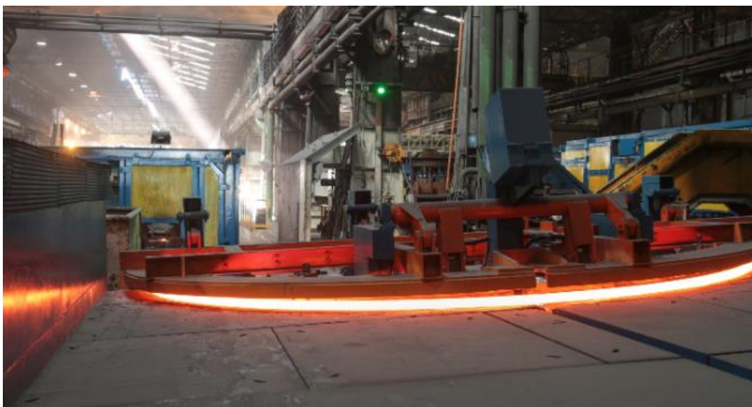
Figura 3- Palanquilla en la dobladora 1 después de pasar por el desbaste y la soldadora (Siderúrgica Sevillana, s.f.)
