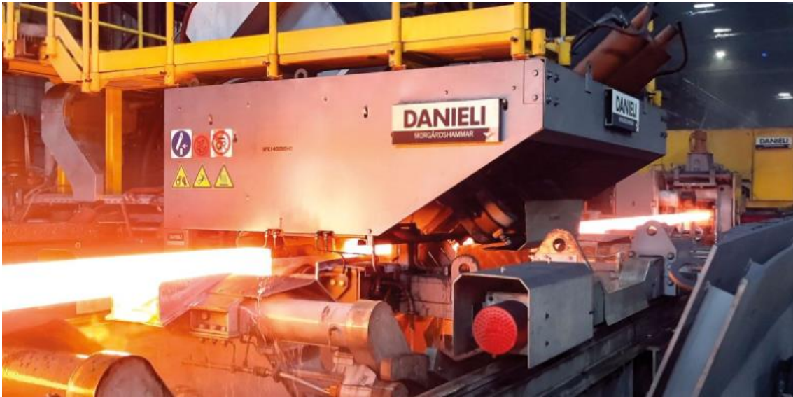
Figura 19- Soldadora de palanquillas en funcionamiento (Siderúrgica Sevillana, s.f.)
