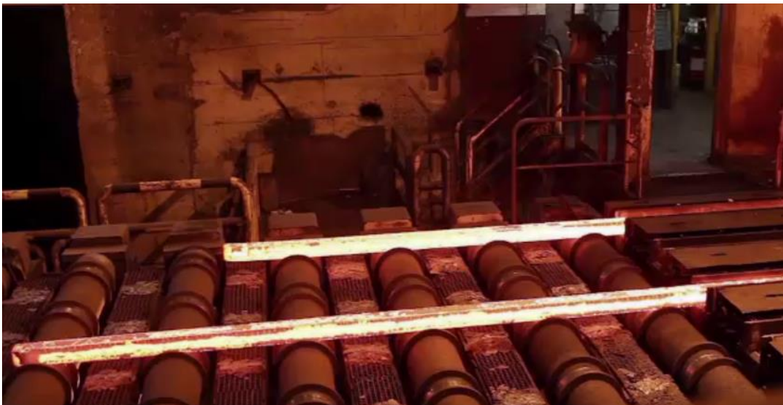
Figura 2- Palanquillas calientes saliendo del proceso de colada continua (Siderúrgica Sevillana, s.f.)
