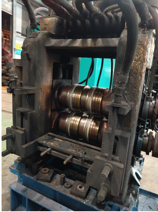
Figura 4- Estructura de caja de laminación en reparación
