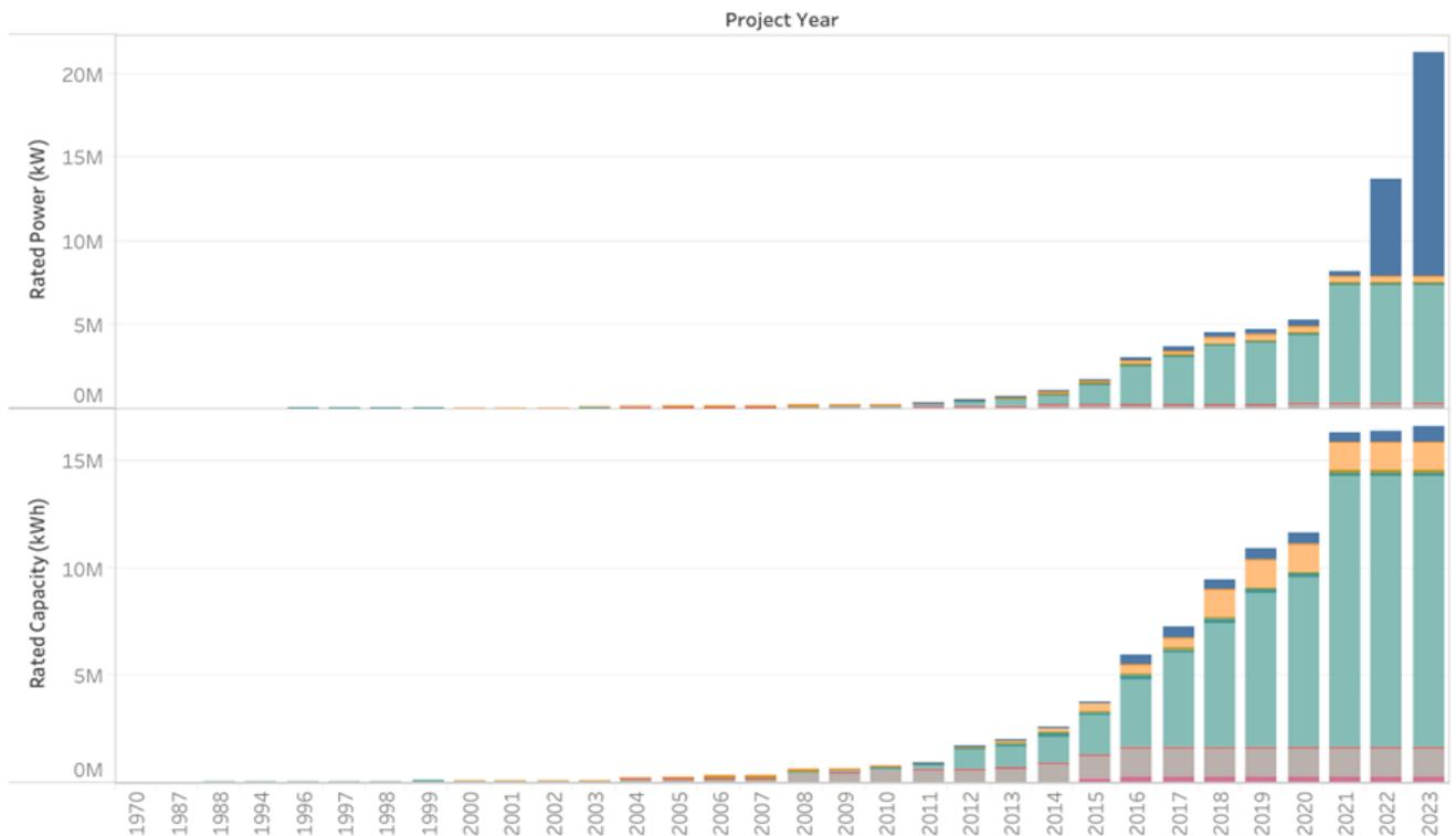
Figura 2-4. Evolución de la energía y potencia instalada mundial de sistemas de almacenamiento electroquímico [1970-2023] [35]
