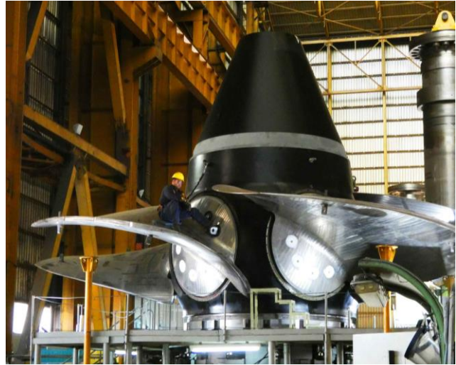
Ilustración 31. Ejemplo de turbina Kaplan. Fuente: (IMPSA, 2024)
