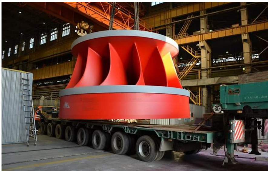
Ilustración 32. Llegada de un nuevo rodete Francis a la CH de Krasnoyarsk, Rusia. Fuente: (Power-m.ru, 2024)
