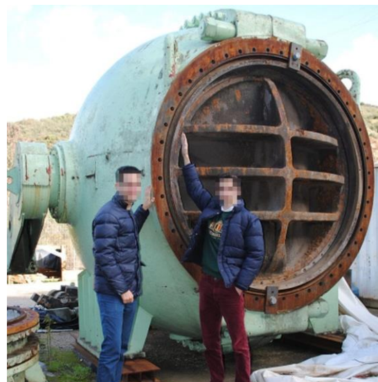
Ilustración 28. Válvula esférica. Fuente: Ramón Abella.
