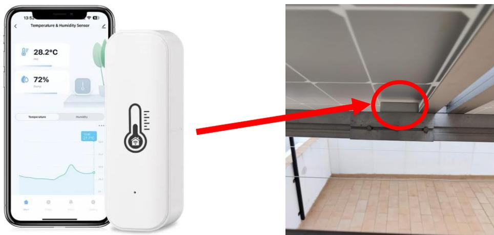
**Figura 3.13** Sensor junto con app colocado bajo panel
