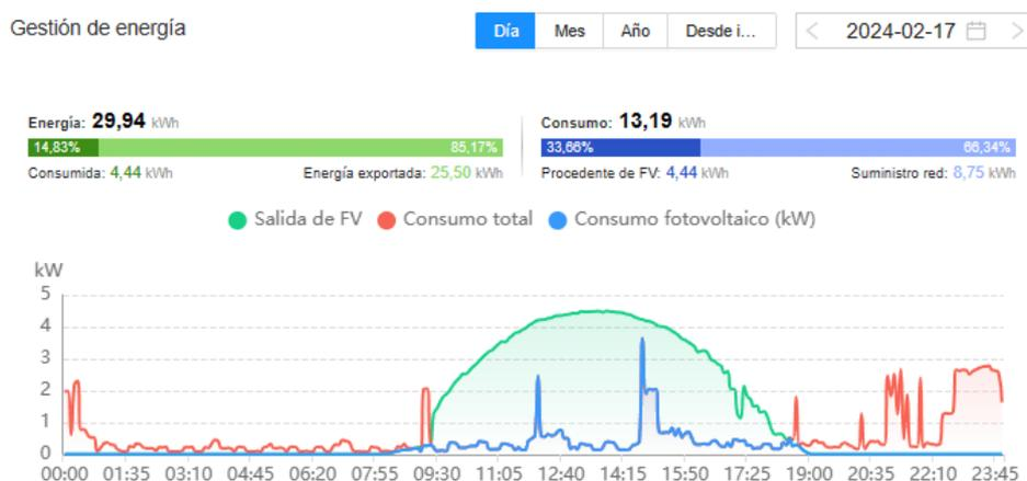
Figura 3.17 Monitorización de la potencia mediante app
