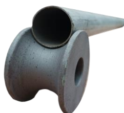
Figura 3.35: Comprobación de la matriz adecuada, mediante la colocación del tubo sobre la sección
