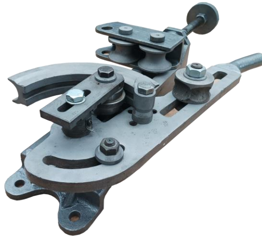
Figura 3.44: Máquina dobladora de tubos limpiada y pintada
