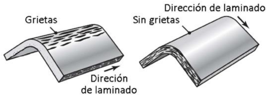
Figura 4.19: Formación de grietas según la dirección de doblado respecto la dirección de los granos
