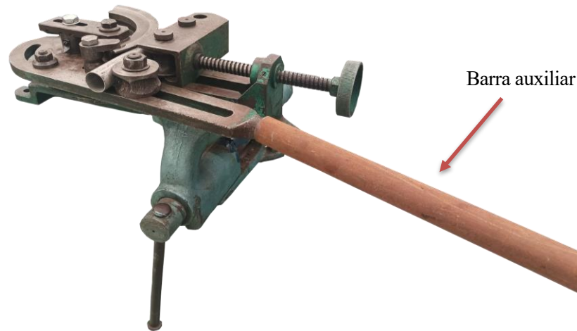
Figura 3.39: Introducción de tubo auxiliar para facilitar el doblado de ciertos tubos
