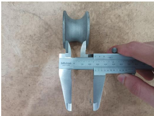
Figura 3.34: Medición de la sección de las matrices de presión a través de: a) Pie de rey b) Galgas de radio
