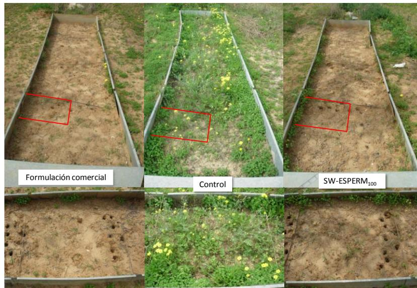
**Figura 68.** Parcelas completas (arriba) y ampliación de un cuarto de las mismas (abajo) sin tratar (control) y tratadas con diurón como formulación comercial convencional y como formulación basada en la organoarcilla SW-ESPERM<sub>100</sub>. El recuadro rojo indica el área de la parcela seleccionada para cuantificar la biomasa.
