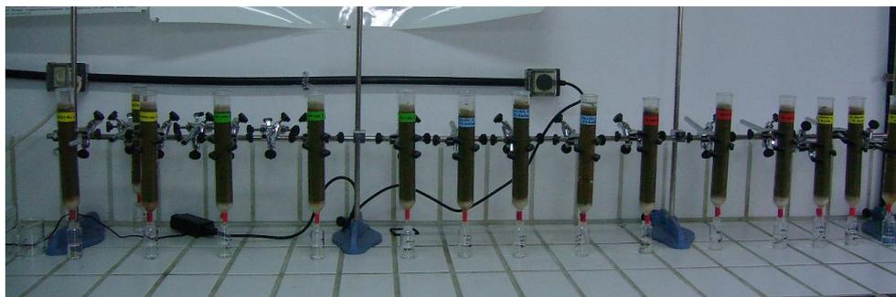
**Figura 25.** Columnas de suelo usadas para el experimento de lixiviación.
