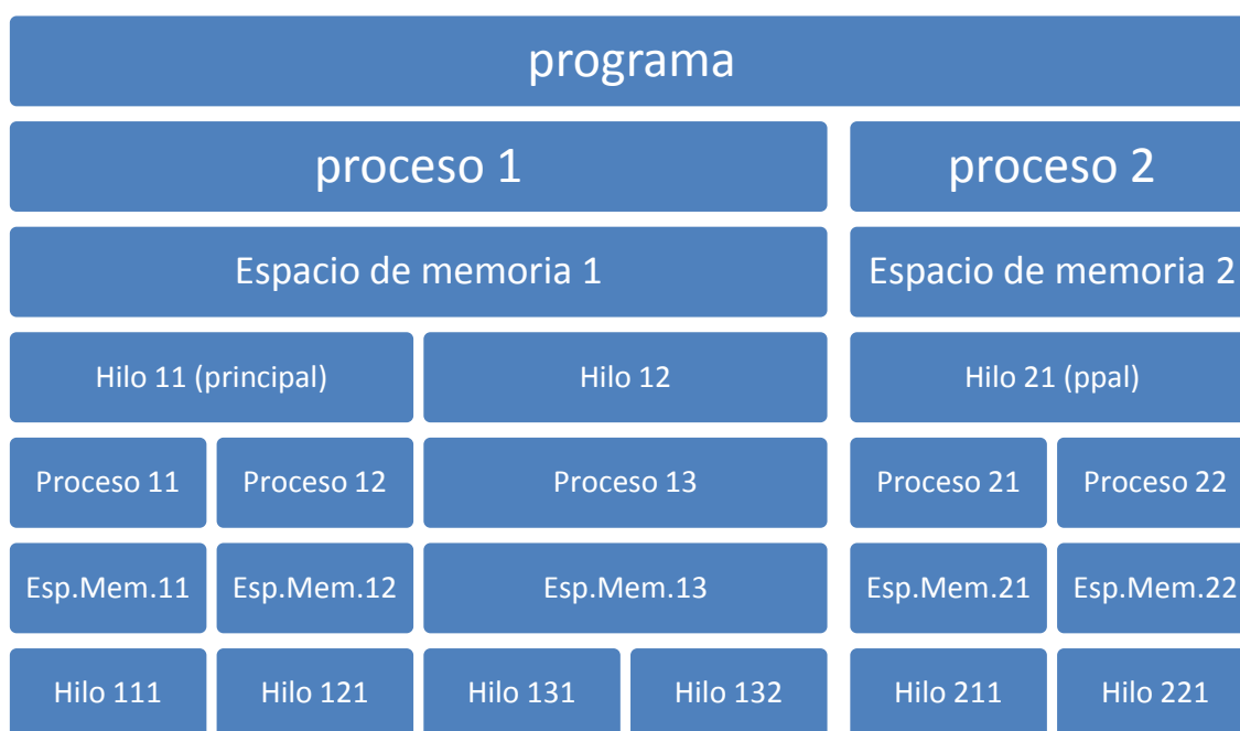
Figura 1: Ejemplo de la división de un programa en procesos y en hilos
