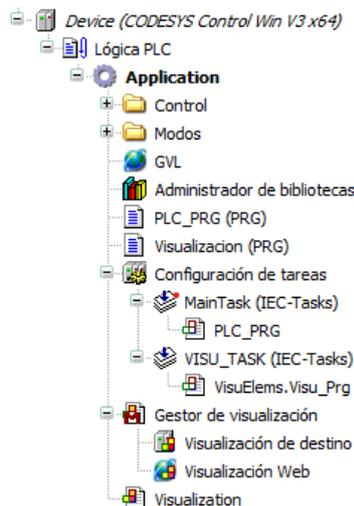
Figura 23: Objetos utilizados para la programación del PLC de la instalación de producción de barriles
