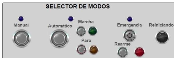
Figura 12: Selector de modos instalación compleja.
