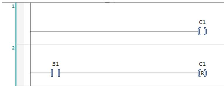
Figura 31: Programa en Ladder para el funcionamiento automático de la cinta 1
