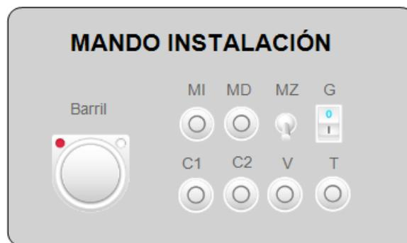
Figura 29: Botones creados para activar cada actuador en el modo manual.
