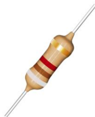
Figura 6-3. Resistencia de orificio pasante
