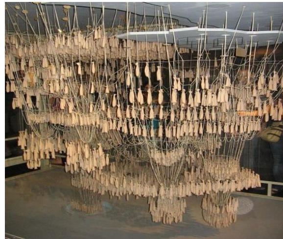
Imagen 3: La reconstrucción del modelo colgante de Gaudí para Colònia Güell (izquierda) y experimentos de Frei Otto con películas jabonosas (derecha). ( https://www.iaacblog.com/programs/sensing-forces/ Fecha de acceso: 22.11.2023)
