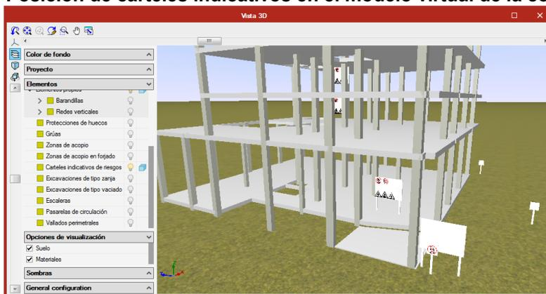
*Representación 3D del vallado perimetral en el VDC (Virtual Design Construction). Mediante la introducción de vallas, el usuario puede acotar las zonas de trabajo, restringir el acceso a la obra y delimitar las zonas de paso de peatones.*
