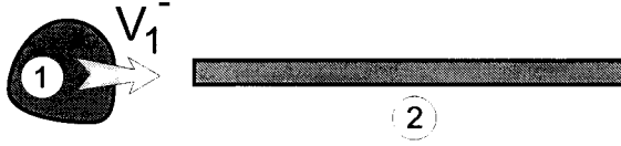
Figura 4.9: Impacto axial de un sólido rígido en una barra flexible libre
