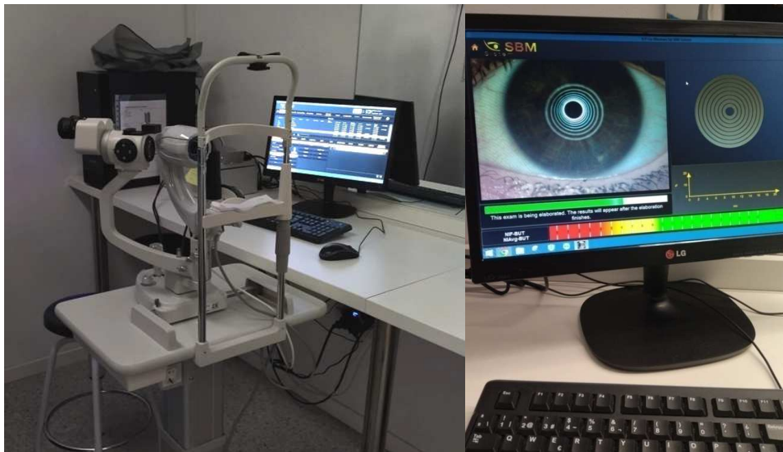
Figura 8. Puesto de medición de los parámetros oculares
