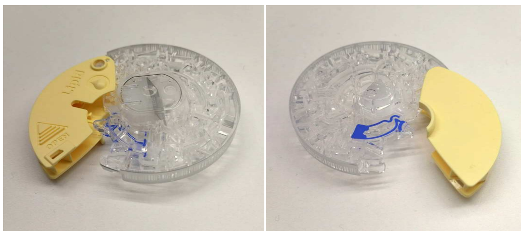
Figura 3. Anverso (izquierda) y reverso (derecha) de los discos reactivos correspondientes al instrumento de análisis cobas b 101
