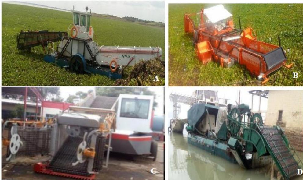
**Figura 21:** Diversos tipos de maquinaria utilizada para la retirada mecánica de *Eichhornia crassipes* en los lugares gravemente afectados (Dechassa & Abate, 2020).
