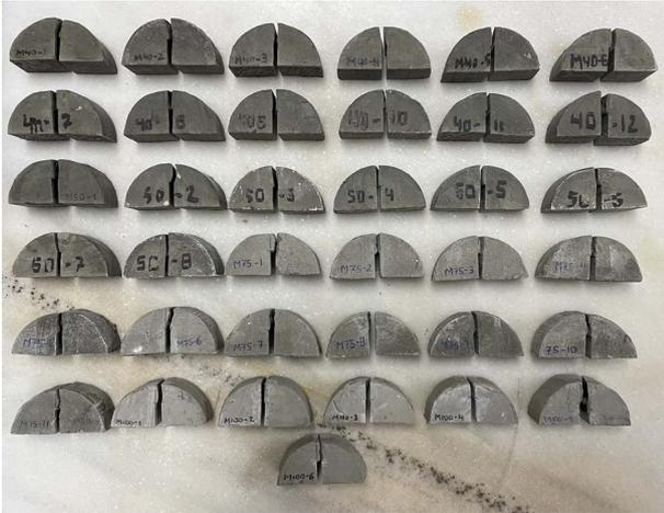
Figura 3: Vista general de las probetas NSCB ensayadas tras su rotura.
