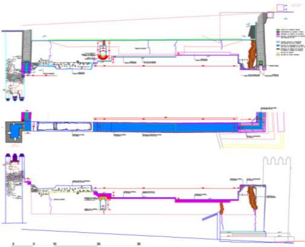
Figura 71. Alzado Norte estado actual Castillo-Alcazaba. Identificación de las intervenciones realizadas hasta la actualidad. Fuente: Elaboración propia a partir del Proyecto de recalce y consolidación de la muralla del Castillo de Bujalance, autor: Juan Jiménez Povedano
