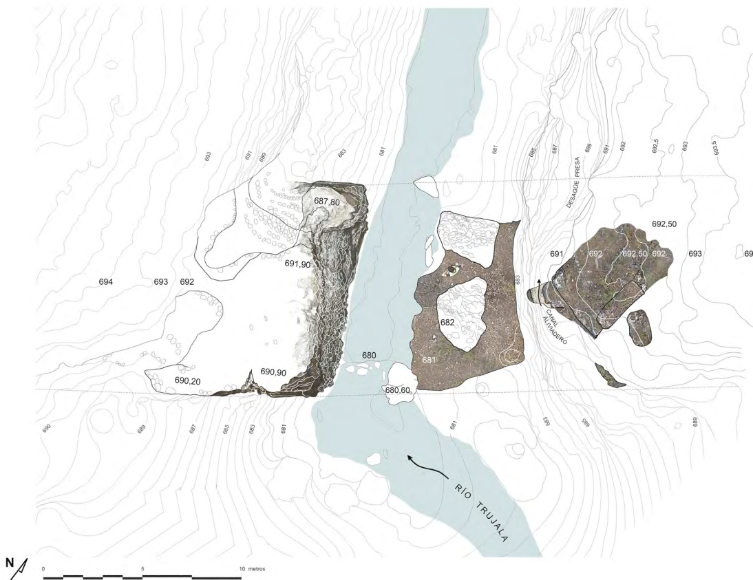
Fig. 13. Levantamiento fotogramétrico en planta de los restos conservados de la presa. El estribo izquierdo se mantiene todavía debido a que se apoya en una pared rocosa con una inclinación de 45°. El estribo derecho prácticamente ha desaparecido, pero aún se conserva la base sobre la que hay escombros desprendidos de la fábrica. En la coronación del estribo derecho hay restos de construcciones e indicios de un posible aliviadero de agua, ya que se aprecia una atarjea tallada en la roca y, justo a continuación, la pared rocosa del cañón presenta una fuerte erosión puntual, quizá consecuencia de la salida del desagüe del embalse en ese punto. Fuente: elaboración propia.
