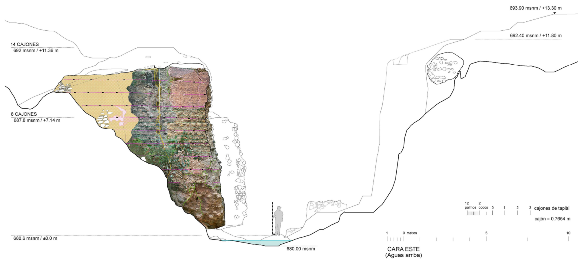
Fig. 11. Representación fotogramétrica, aguas arriba, del estribo izquierdo de la presa, y de los vestigios aún conservados en la base del margen derecho. Se aprecia con nitidez la tecnología constructiva empleada en su construcción, realizada con una fábrica de hiladas de calicanto encofradas con cajones de tapial y revestimiento de cal. En esta cara se conservan hasta 14 cajones, equivalentes a una altura de 11,36 m. La anchura media del cajón es de 76,54 cm y la distancia de las agujas es de 65-70 cm. Fuente: elaboración propia.
