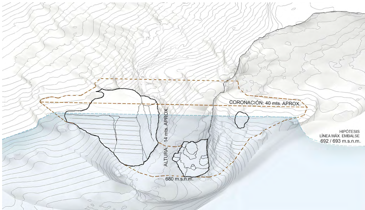
Fig. 12. Reconstrucción volumétrica de la presa, con representación de los restos aún conservados. La longitud de coronación estimada sería de unos 40 metros y la altura desde el lecho del río de unos 14 metros como mínimo. Las líneas de curvado topográficas muestran los encajes de la fábrica en la roca. Igualmente es significativa la erosión del terreno en la base delantera del dique, indicio claro de la erosión del terreno kárstico que minó la base de la presa. Fuente: elaboración propia.
