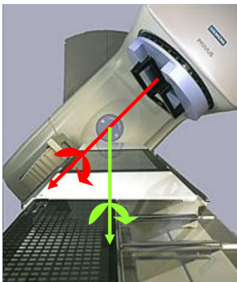
Figura 3.2: Rotaciones isocéntricas que puede realizar un acelerador para radioterapia (en la figura, modelo PRIMUS de Siemens). Se representan el eje de rotación del gantry (verde) y el eje de rotación de la parte móvil del cabezal (rojo).
