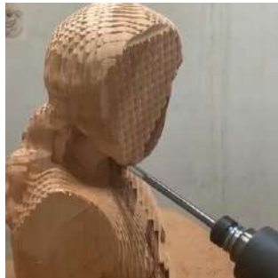
Figura 18. Tallado de piezas mediante máquina de control numérico CNC. (Juan Bautista 2021)
