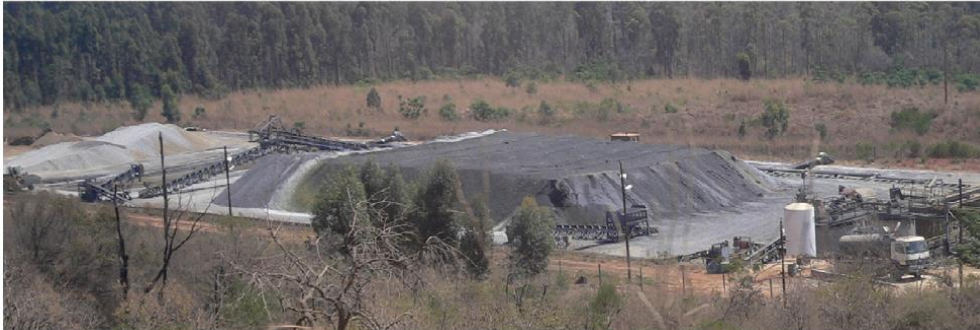
Figura 10. Pila de pre-tratamiento biológico en Agnes, Sudáfrica. Fuente: Kaksonen, Mudunuru, et al. (2014).
