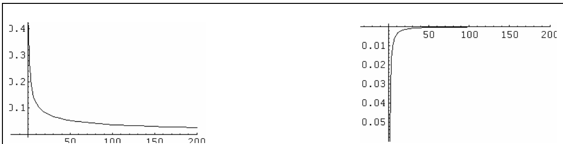
Figura 7: Las autocorrelaciones en un ruido negro, incrementos correspondientes a un movimiento browniano fraccionario persistente \frac{1}{2} < H < 1 son positivas, de forma que si el proceso ha crecido en un intervalo tiende a aumentar en el siguiente (o a disminuir si ha decrecido en el otro). En un ruido rosa, incrementos correspondientes a un movimiento browniano fraccionario antipersistente 0 < H < \frac{1}{2} son negativas, de forma que sucede lo contrario: si el proceso ha crecido en un intervalo tiende a disminuir en el siguiente (o a aumentar si ha decrecido en el otro).
