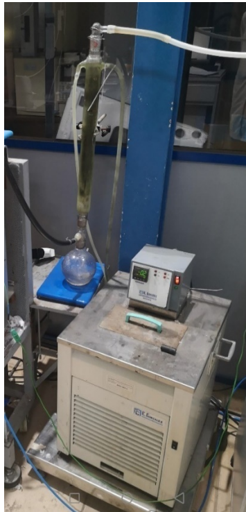
Figura 17. Unidad de condensado y tanque de refrigeramiento
