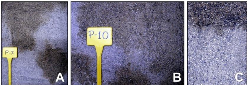
**Figura 33. Patrones de humedad en perfiles de suelo excavados en dunas tras las simulaciones de lluvia. A-B: dos vistas detalladas de vías de flujo preferencial en perfiles de suelo bajo pinar. C: frente de mojado homogéneo en un perfil de suelo bajo vegetación herbácea dispersa.**
