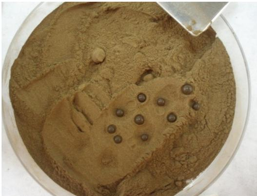
**Figura 2. Gotas de agua sobre agregados finos de un suelo quemado (fotografía: Borja Segovia)**
