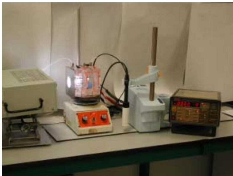
Fig. 2.25.- Fotografía de los distintos aparatos utilizados para realizar las medidas de fotocorriente: Lámpara de Xe, celda fotoelectroquímica, medidor de O_2 y medidor de corriente.
