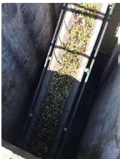
Figura XX: Transporte de tolva a máquinas de limpieza
