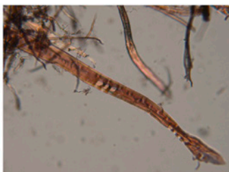
Fibras madereras de conifera: punteaduras de campo de cruce de tipo fenestriforme, 100X. (Foto: Lourdes Martín).
