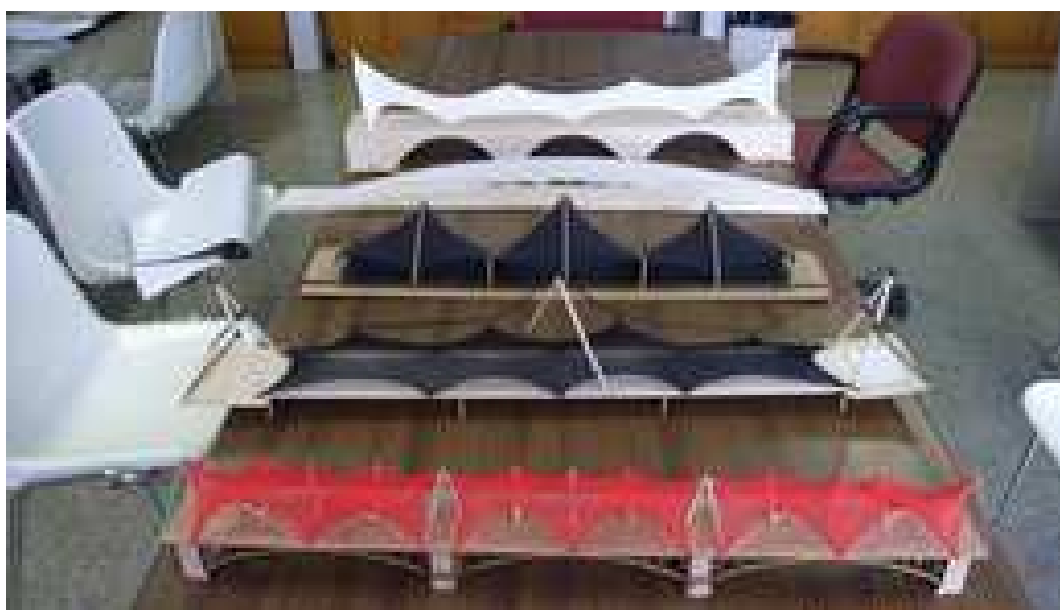
Figuras 4. Análisis en modelo reducido de propuestas para cubrir el puente de Isabel II en Sevilla.
