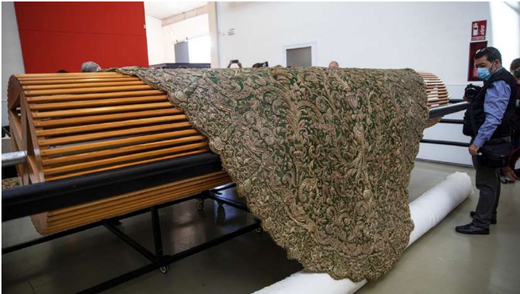
Figura 13: Rodillo de gran tamaño para el manejo adecuado de las obras de gran formato
