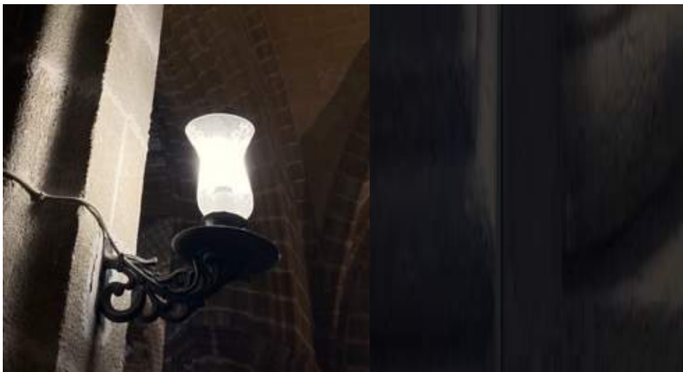
Ilustración 20: Principales sistemas de iluminación, ambas de tipo LED. Por un lado, esta lámpara de tulipa con bombilla de marca BENEITO FAURE, modelo BEN582L016T40E-C3, con iluminación de 360°, 10W y de temperatura de color fría (izq). Por otro lado, foco de marca BENEITO FAURE, modelo 243113-N2, de 40W y una temperatura de color de 2700°K(dcha). [Imágenes tomadas por Pablo Tejero Cárdenas, 2023]
