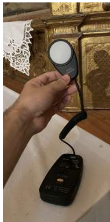
Ilustración 19: Luxómetro KPS-LX10 realizando mediciones de iluminancia en el Retablo de san Cristóbal, capilla NEV2_1, con unos valores de resultado de un rango entre 14-16lux. [Imagen tomada por Pablo Tejero Cárdenas, 2023]
