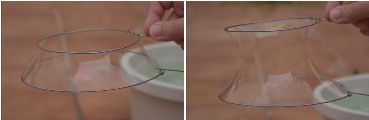
Figura 4.5: Trozo de catenoide (el aro superior es de menor diámetro que el inferior).
