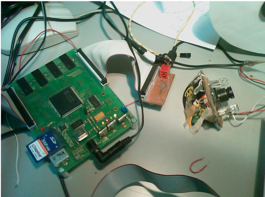
*Ilustración 3.14: Placa USB-AER con ADC y cámara*
