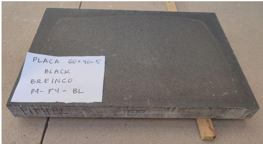
Figura 64. Fotografía pavimento Black Breinco. Fuente: Elaboración propia
