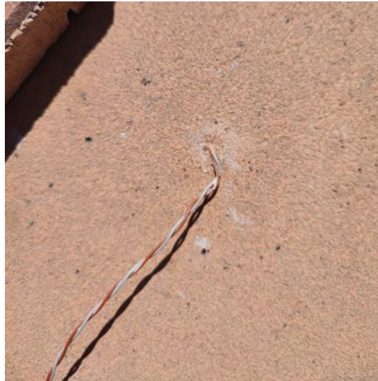
Figura 16. Fotografía del método de colocación del termopar en pavimentos. Fuente: Elaboración propia.
