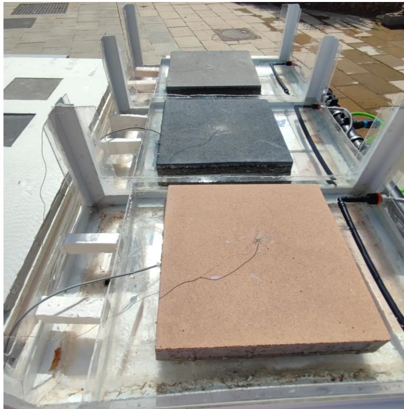
Figura 21. Fotografía de pavimentos húmedos y esquema de rebosadero. Fuente: Elaboración propia.
