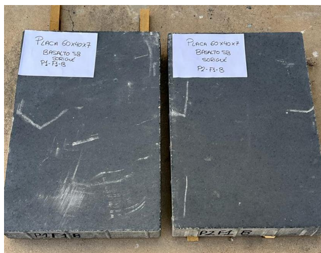
Figura 57. Fotografía pavimento Negro Sorigué. Fuente: Elaboración propia.
