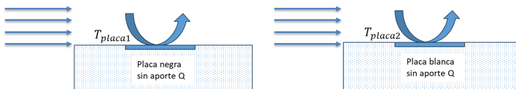
Figura 31. Esquema de experimentación para cálculo de absorptividad de placas. Fuente: Elaboración propia.
