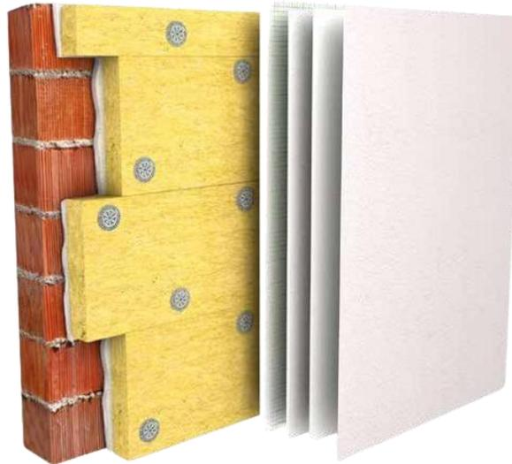
*Figura 4. – SATE (Sistema de Aislamiento Térmico Exterior)*
