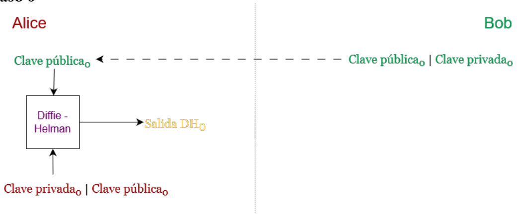
Figura 7.2: Bob envía su clave pública a Alice y desconoce la clave pública de Alice.
