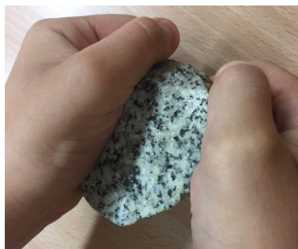
Figura 15. Comprobando compacidad del granito
