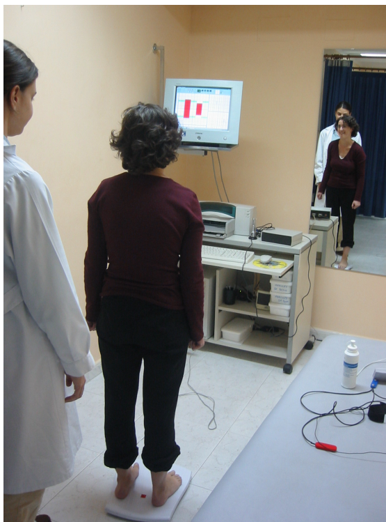
FIGURA 3.2. PACIENTE DURANTE UNA SESIÓN DE ENTRENAMIENTO DEL EQUILIBRIO EN LA PLATAFORMA ESTABILOFORME Y LA GRAFICA GENERADA POR EL SISTEMA PARA OFRECER EL FEEDBACK AL PACIENTE.
