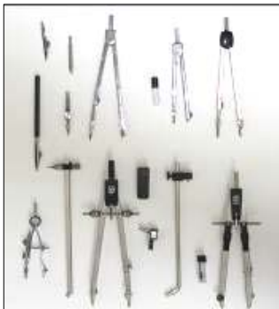
Fig. 5: Compás, bigoterías y algunos elementos auxiliares
