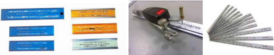
Fig. 7: Normógrafos o plantillas de letras de distintos tamaños y colores y "cangrejo" con juegos de regletas
