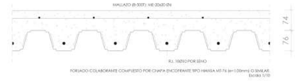
FORJADO COLABORANTE COMPOSTO POR CHAPA INCOEFICIENTE TIPO HANSA M-76 (h=1.00mm) O SIMILAR. Escala 1/10
