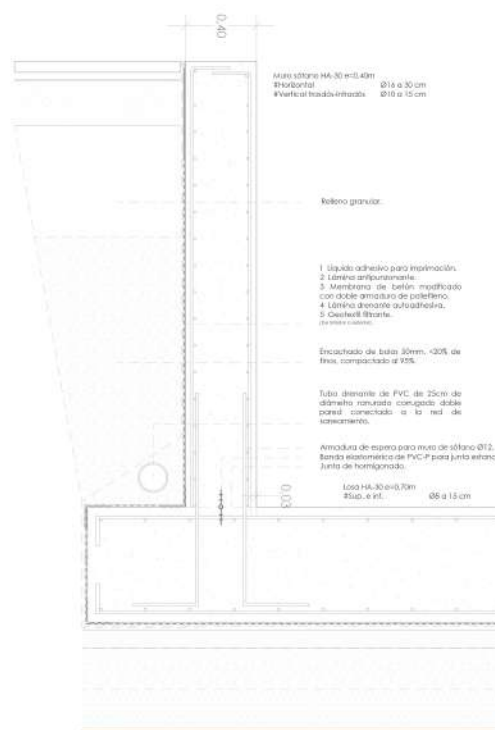
ENCUENTRO MURO DE SÓTANO Escala 1/15
