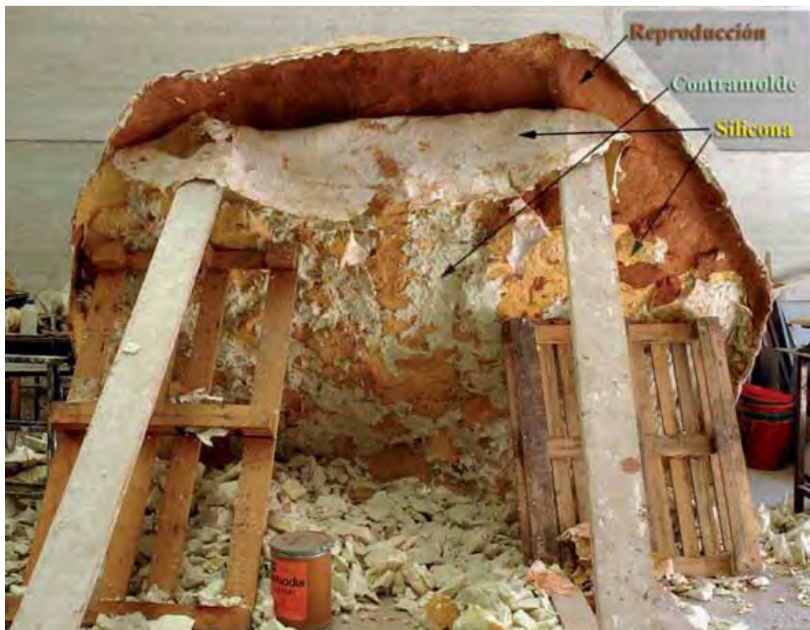
Lámina 10.85. Progreso del desbastado que provoca la separación del caucho y la aparición de la reproducción de resina.
