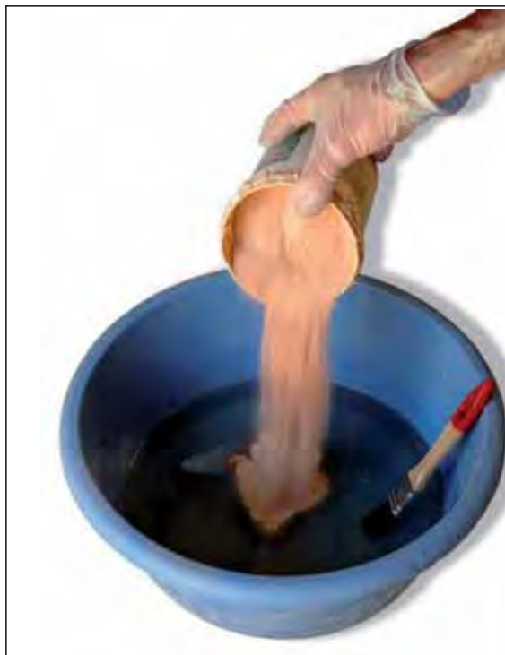
Lámina 10.64. Incorporación de la tierra tamizada.
