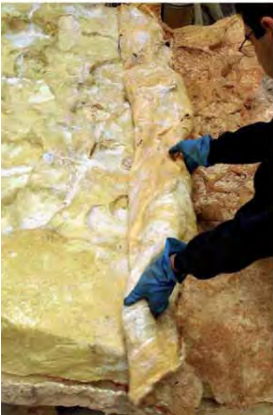
Lámina 10.57. Despliegue de la silicona sobre el contramolde.
