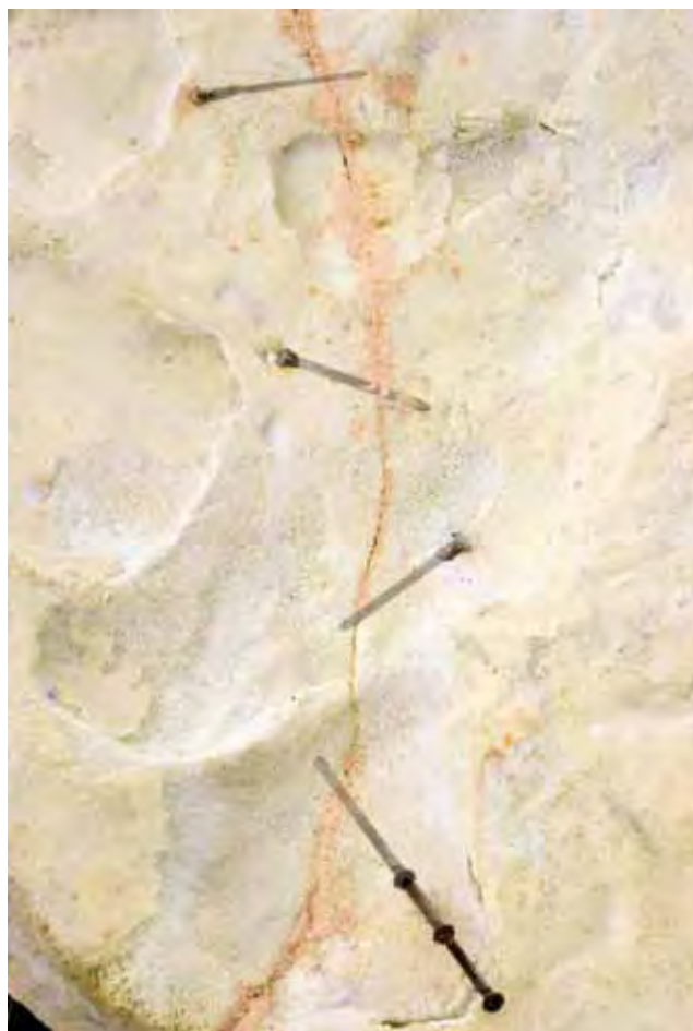
Lámina 10.38. “Radiografía” y secuencia de la ubicación de los clavos de sujeción.
