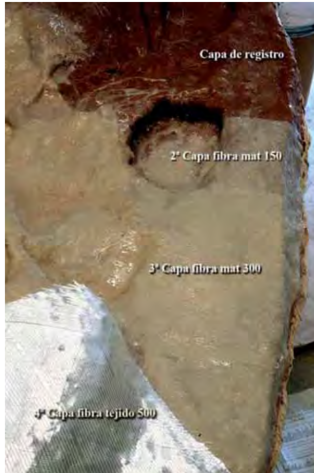
Lámina 10.68. Vista esquema de los diferentes estratos.
