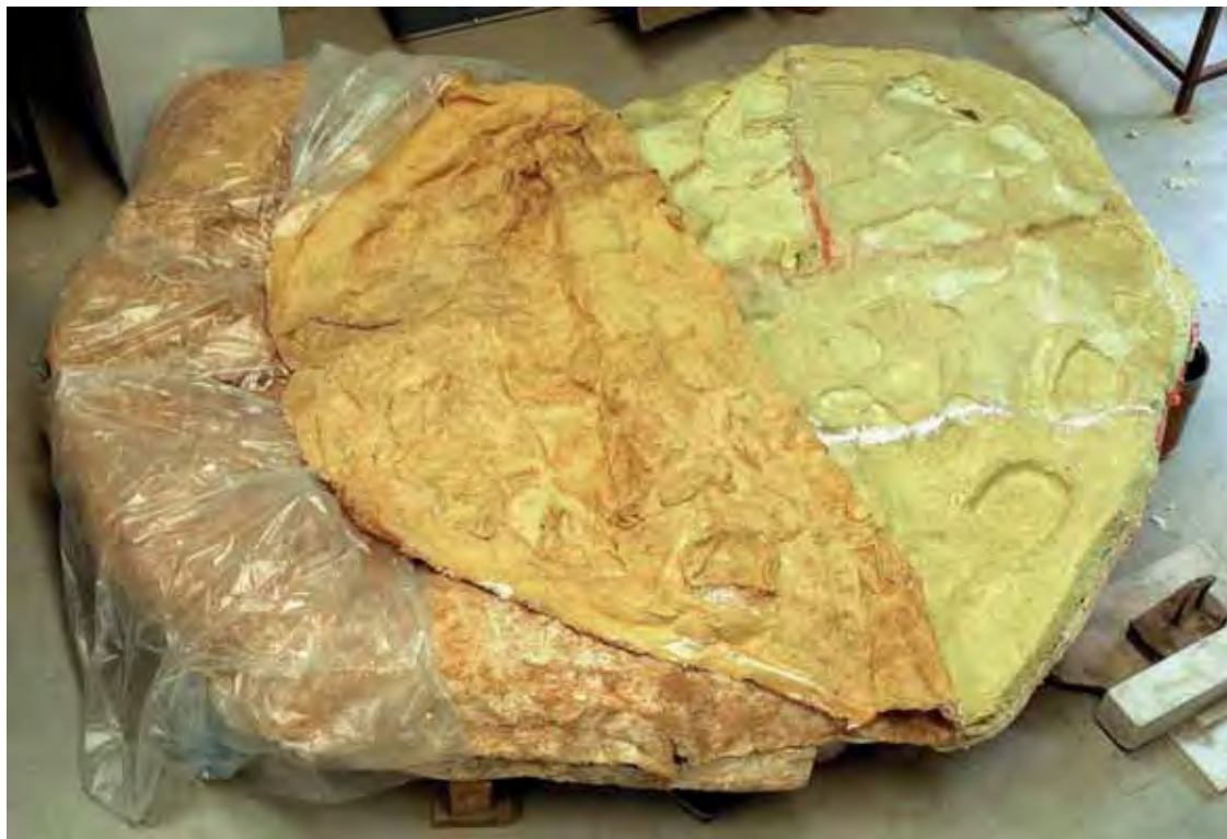
Lámina 10.53. Vista general del molde del suelo con la silicona de la mitad derecha desplegada sobre la izquierda.
