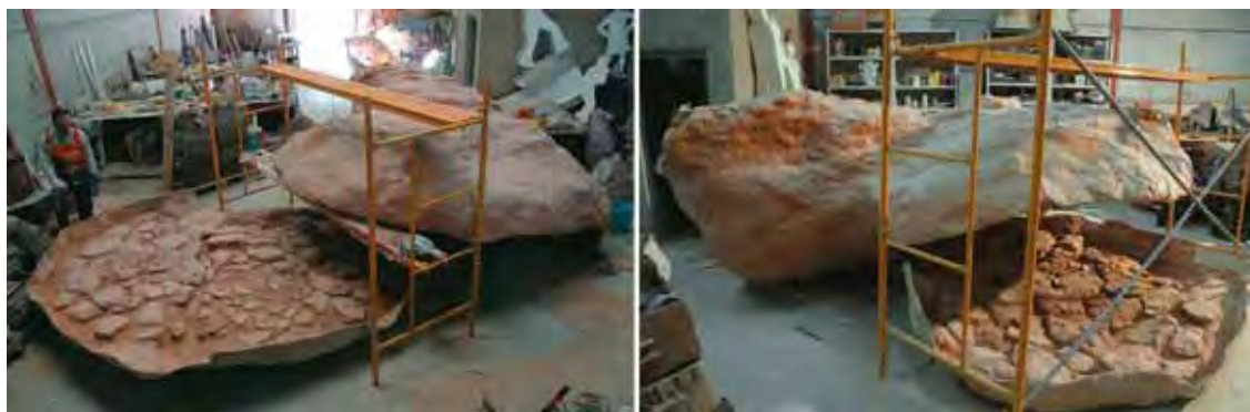
Lámina 10.93. Imágenes de la reunión de las dos piezas principales de la cueva conformadas independientemente.
