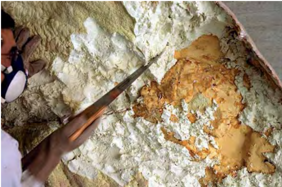
Lámina 10.84. Desbastado del contramolde con el serrucho. Éste va descubriendo la cara exterior del molde flexible de silicona.
