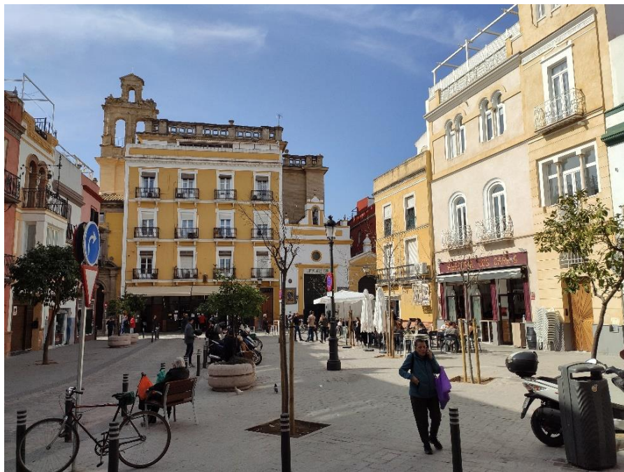
Figura 3. Plaza de Montesión, Sevilla. Una urbanización de 2022 perpetúa el pavimento impermeable, oscuro y el arbolado escaso y de porte menor, con alcorques insuficientes
