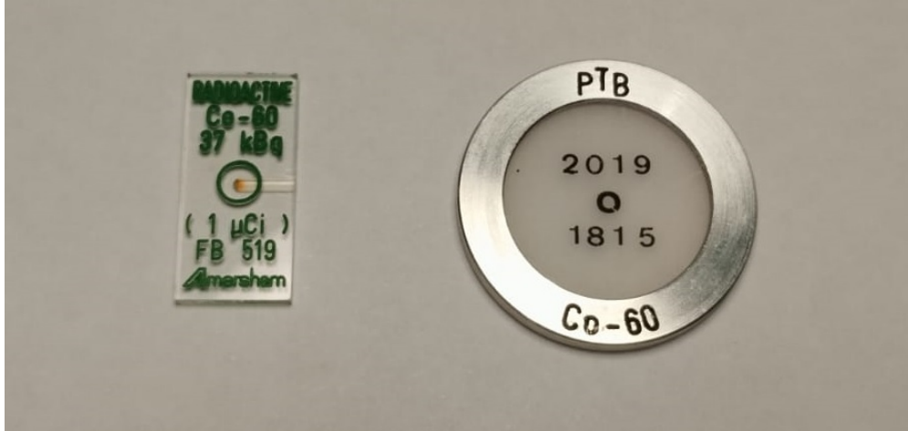
Figura 8: Fuentes radiactivas de ^{60}\text{Co} de Amersham (izquierda) y PTB (derecha).
