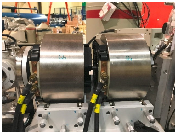
Figura 2-11 Pares de cuadrupolos magnéticos usados para el enfoque del haz.
