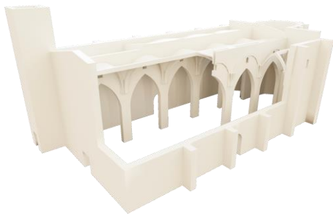
Figura 1. Iglesia de Santa Ana. Representación del modelo geométrico con las simplificaciones adoptadas.
