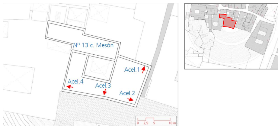
Figura 9. Situación de los acelerómetros de referencia.
